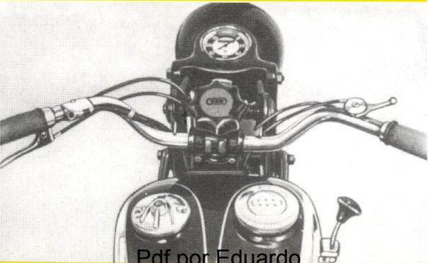
In Gummi schwingungsfrei gelagerte Lenker mit griffnahen Bedienungshebeln, und indirekt beleuchtbares Tachometer.
